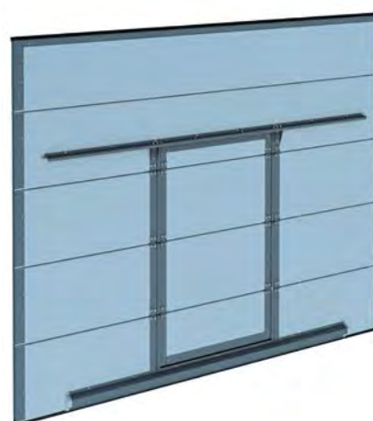
Калитка со стандартным порогом 145 мм
