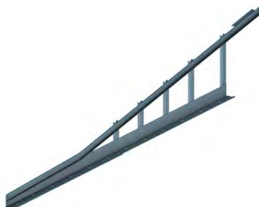
(HKI-52, 53) Угловая стойка, состоящая из цельного профиля
