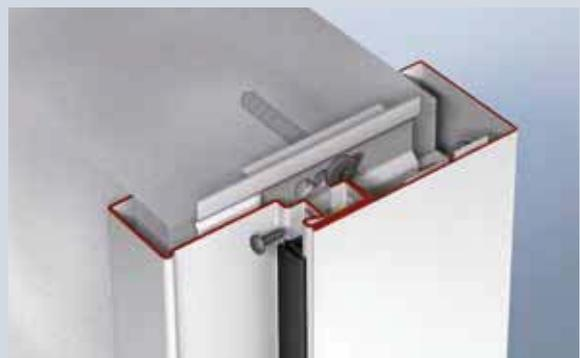
Через канавку для уплотнения соединить винтами профиль 2 доборной коробки с профилем 1 и затем вставить поверх данного соединения уплотнение двери
